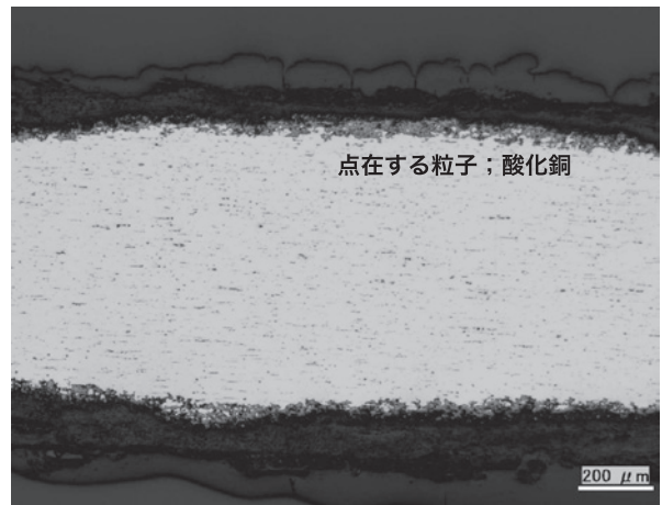
写真8 試料8（銅線）の外観と断面組織
